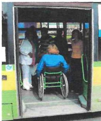
Рисунок 2.16.8 — Отсутствие площадки для представителя МГН в подвижном составе
