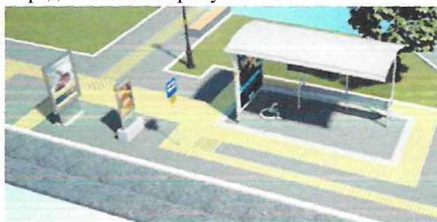
Рисунок 2.16.13 - Предложения по расположению тактильной плитки на остановочном пункте
