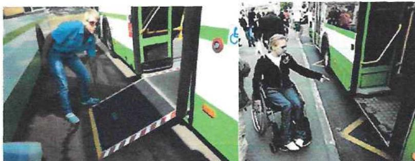
Рисунок 2.16.7 - Зазор между транспортным средством и бортовым камнем остановочного пункта
