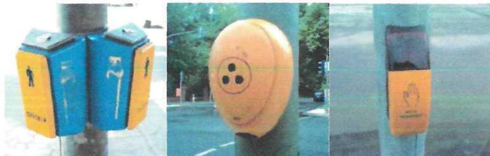
Рисунок 2.16.6 - Пример осязательного сигнала пешеходного перехода
